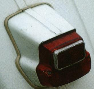
Il fanalino posteriore originale SIEM con basetta in alluminio
